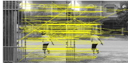
图6 SIFT+RANSAC算法实验结果
