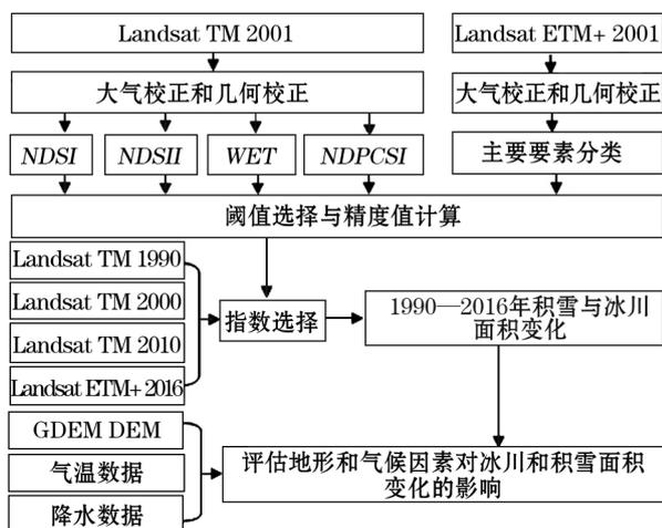
图 2 冰川和积雪监测流程
